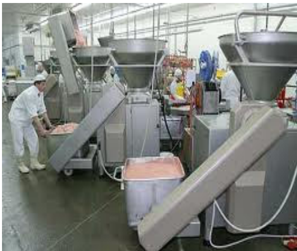
24 сурет. Шұжықты шприцтеу үдерісі
