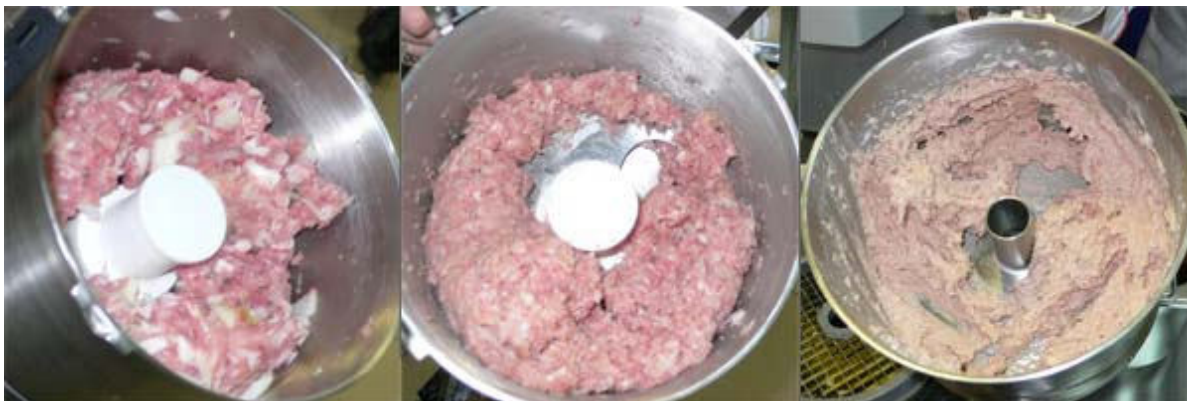
23 сурет. Куттер аспабымен етті майдалау
