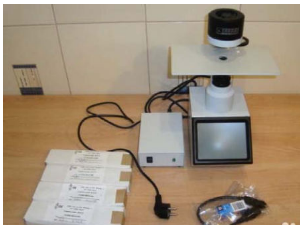
19 сурет. «Стейк» электронды трихинеллоскоптың жалпы көрінісі
