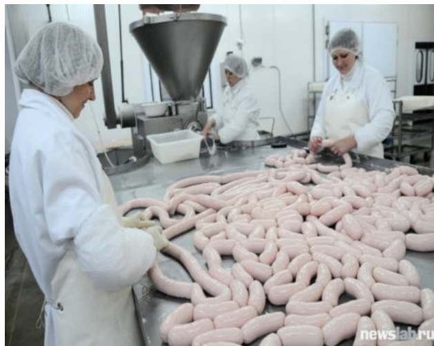
24 сурет. Шұжықты шприцтеу үдерісі
