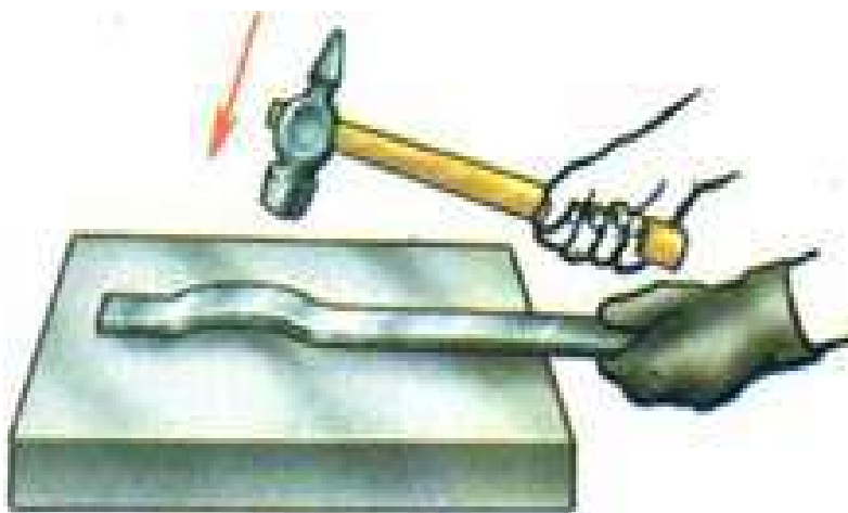
6.8-сурет - Кең жазықтық бойынша иілген болат жолақты түзету.
