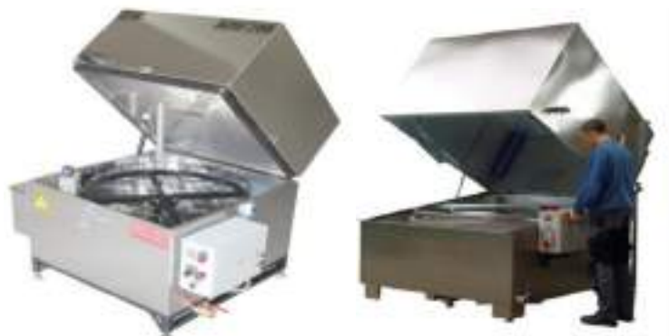
Сурет 8.43-Бөлшектерді жууға арналған торлы айналмалы барабанды машина
