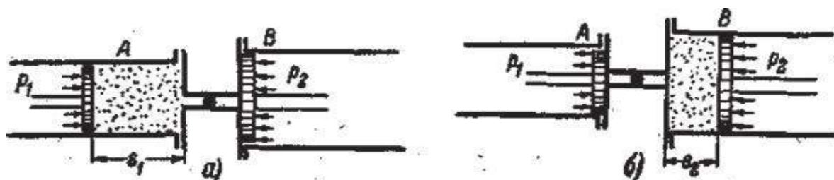
Сурет 3.4- Газдың жаншуға дейінгі (а) қалпы және жаншудан кейінгі қалпы (б)
