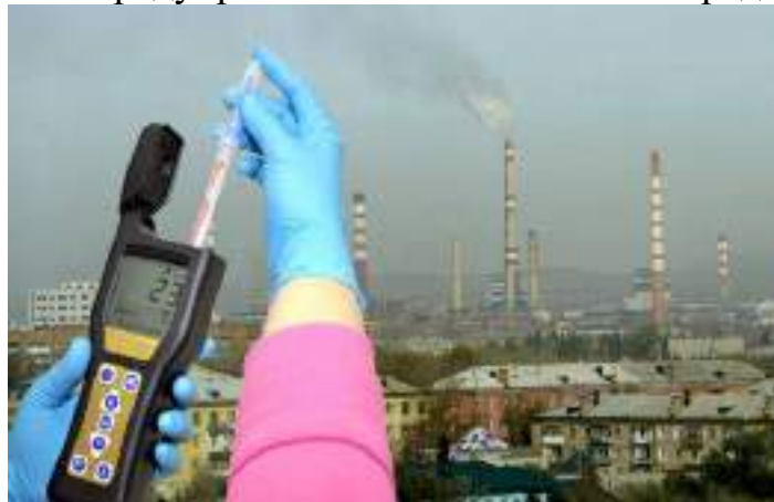
Сурет 6.8- Индикатор түтікшесі - ауаның газбен ластануын өлшеу приборы
