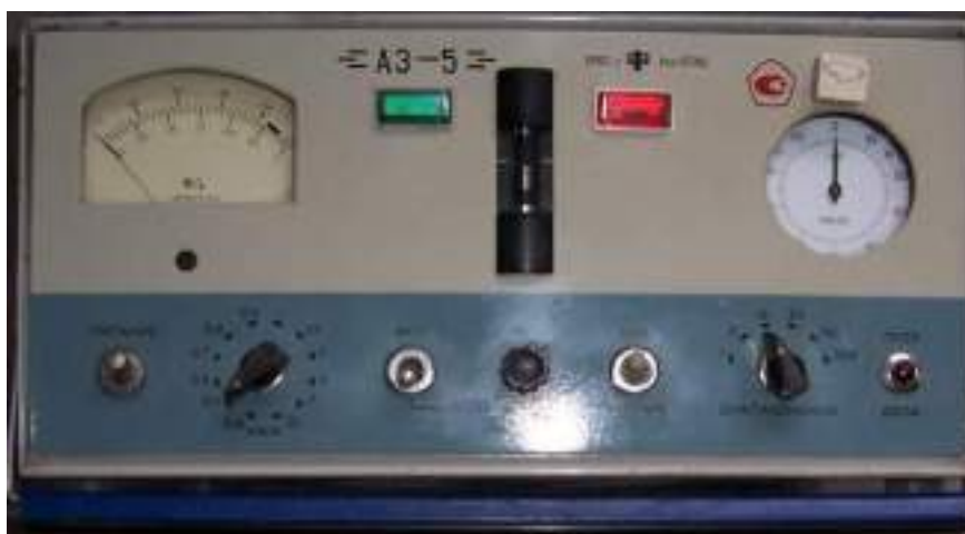
Сурет 6.9- Ауаның шаңмен ластануын өлшеу АЗ-5 приборы
