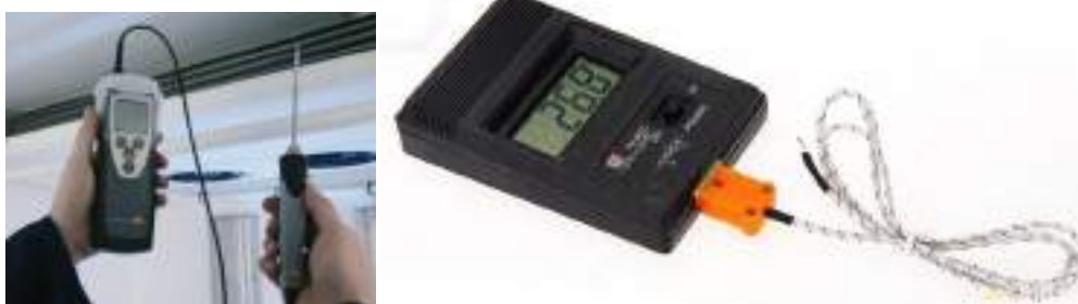
Сурет 6.4-Ауаның температурасын өлшеу приборы (термопара)
