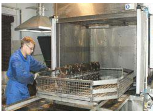
Сурет 8.40- Бөлшектерді батырып жуу үшін арналған ванна 1-желедеткіш, 2- құбыр желісі, 3- сорап, 4- ерітіндіні қыздыруға арналған құрылғы, 5- тор, 6- құбыр ұшы
