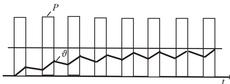
2.1.2.3-сурет. Машинаның қызуы мен салқындауының уақытқа тәуелділігі
