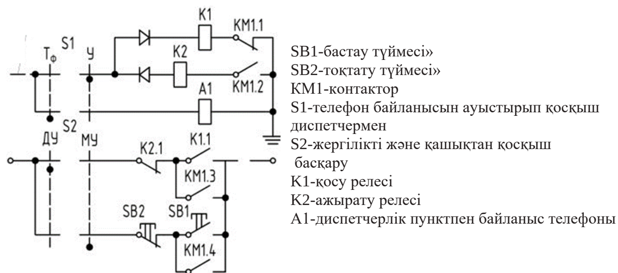
2.3.3.10-сурет. Жергілікті басқару пультіндегі конвейерді іске қосуды және тоқтатуды басқару схемасының элементтері
