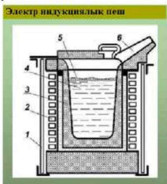
2.3.1.4-сурет. Индукциялық тигель пешінің схемасы:
