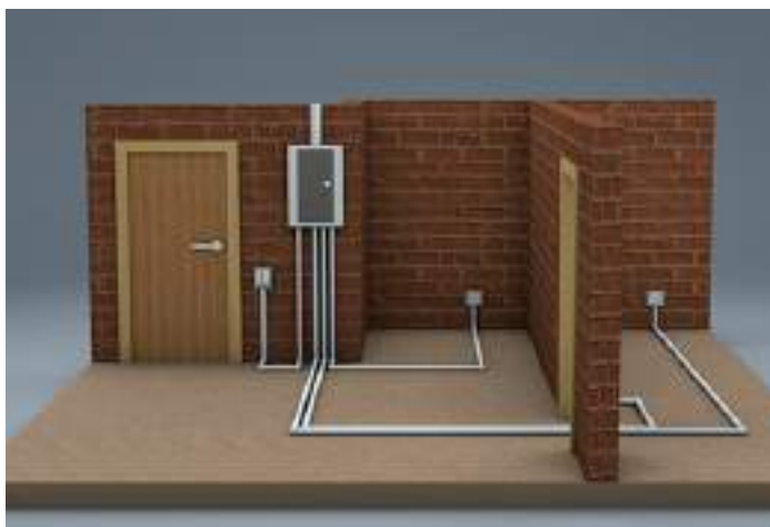
2.2.4.7 -сурет. Еден астындағы кабель мен сымдарды төсеу түрі.
